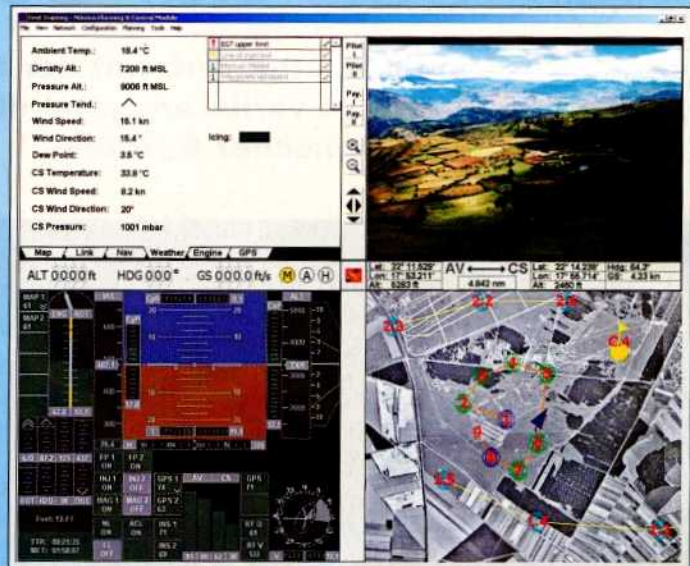
Bildschirmansicht der Kontrolleinheit: So kann der Flug des Camcopters vom Boden aus live mitverfolgt werden.
