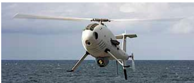
CAMCOPTER mit EQ / IR -Sensor POP 200 der Firma IAI Tamam
