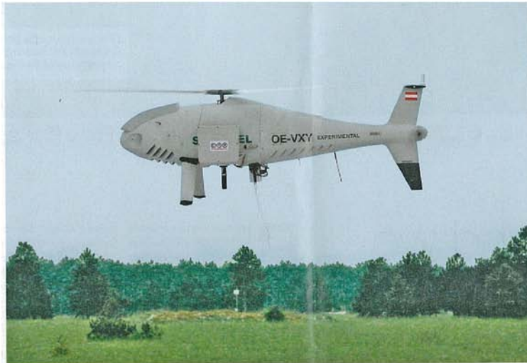
Eine Drohne der Firma Schiebel wurde mit einem Hightech-Gerät ausgestattet, um aus der Luft Bodenbeschaffenheit und Vitalität von Pflanzen zu messen.
