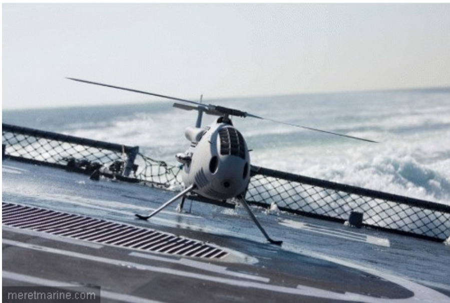
Le Camcopter S-100 sur la plateforme hélicoptère d'un bâtiment The CAMCOPTER S-100 on a Ship's Helipad
