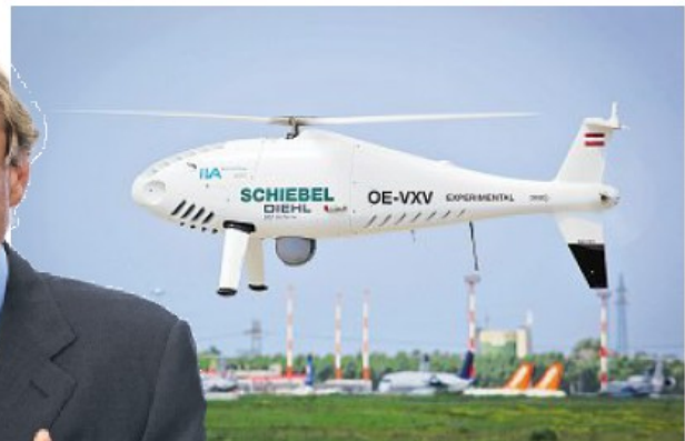
Die drei Meter langen unbemannten Hubschrauber von Schiebel können 50 kg zuladen und 10 Stunden in der Luft bleiben
